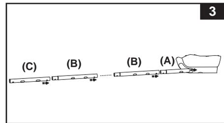
Die Löcher der Stangen müssen deckungsgleich mit den Löchern der weißen Schlaufe sein. Danach schieben Sie alle "A-B-C & D-E-F" Stangen in die Laschenöffnungen. Beginnen Sie mit der „D-E-F“ Kombination für die kürzere Seite des Pools und stecken Sie zuerst die „D“ Stange in die Öffnungen. Die Kombination von Stangen ist je nach Poolgröße verschieden, siehe Tabelle unterhalb. (Versichern Sie sich, dass an allen 4 Seiten die Löcher der Stangen mit den Löchern in der weißen Lasche übereinstimmen.)
