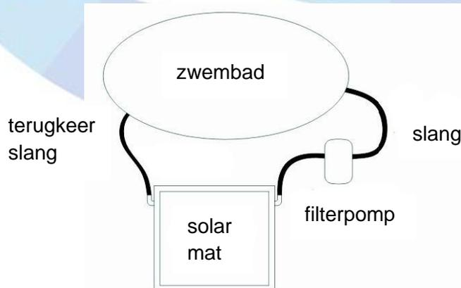
\* Bovenstaande tekening is alleen ter demonstratie, de lay-out van de leidingen dient enkel ter referentie. De tekening is illustratief en niet op schaal, afmetingen kunnen afwijken het van bijgesloten product.
